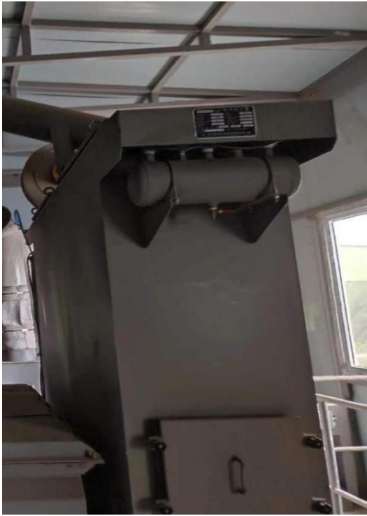
搅拌机除尘器
